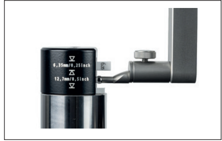
그림 13 홀을 포함해 교정할 때 세팅 게이지의 위치 이동
