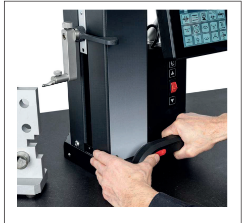
그림 8 활성화된 에어베어링을 사용해 하이트 게이지를 이동
